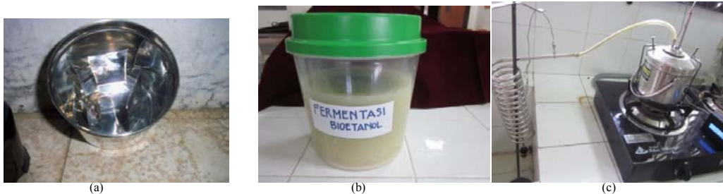
Gambar 6 .(a) Evaporator pada proses detilasi dengan inovasi pemasangan 3 sirip, (b) Hasil Fermentasi Nasi + sayur selama 3-4 hari, (c) Proses destilasi Bioetanol menggunakan inovasi pada evaporator dan regulator
