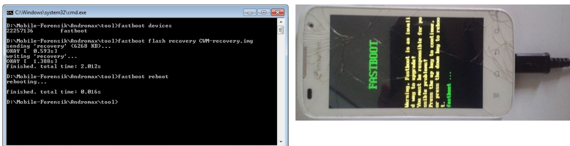
Gambar 4. Proses Instalasi CWM pada Smartphone 2 dengan tools fastboot
