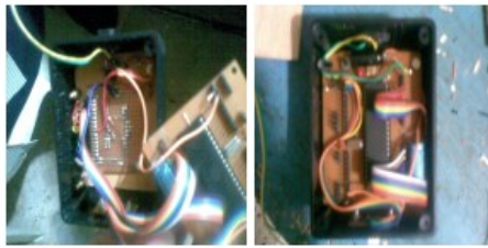
Gambar 7. Pemasangan komponen ke dalam kotak rangkaian bagian utama
