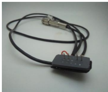
Gambar 1. Elektroda 4 jarum berbahan perak
