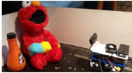
Gambar 3.12 Metode uji deteksi bentuk yang berbeda dengan boneka
