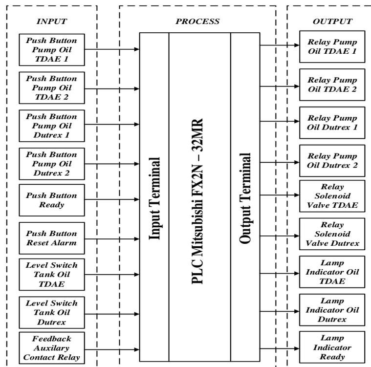
Fig. 3. Block Diagram
